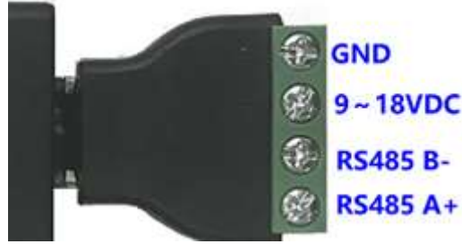
Figure 5. DelcomRF Derya-GPRS 4PIN Konektör Bağlantı Açıklaması
